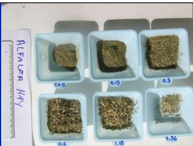
Fieno di medica setacciato per misurarne la dimensione delle particelle
