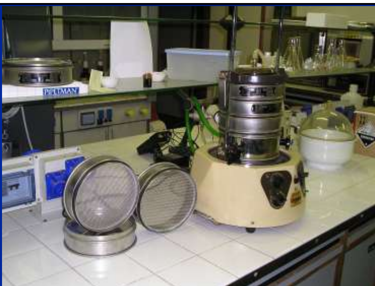
Setacciatore per misurare la dimensione delle particelle degli alimenti in laboratorio
